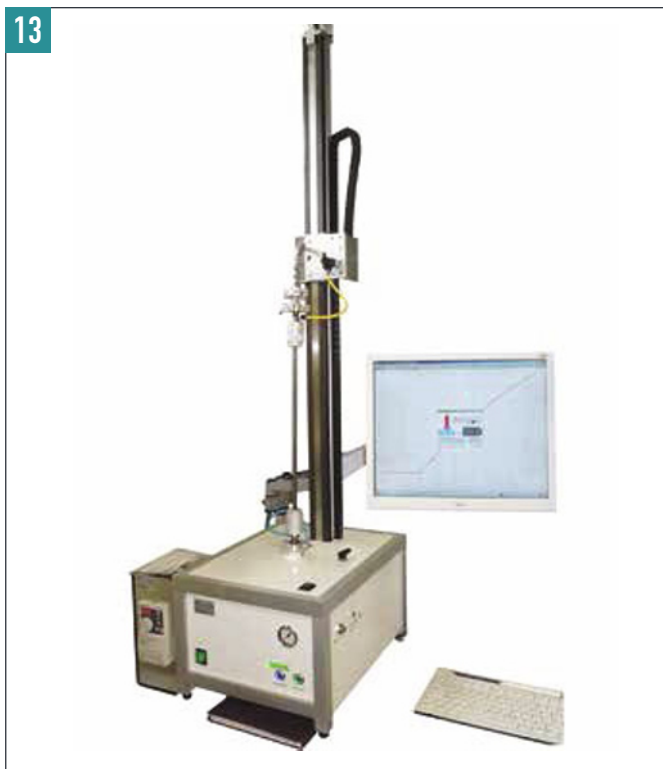
Bild 13 • Testapparatur zur Bestimmung der Leckagerate von Membranen
