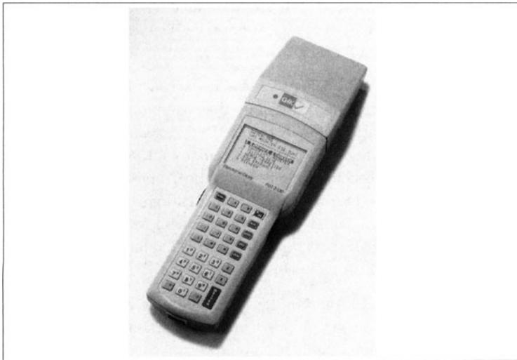
Abbildung 1: Electronic Diary Gerät zur Erfassung von Haushaltseinkäufen (Quelle: GfK)
